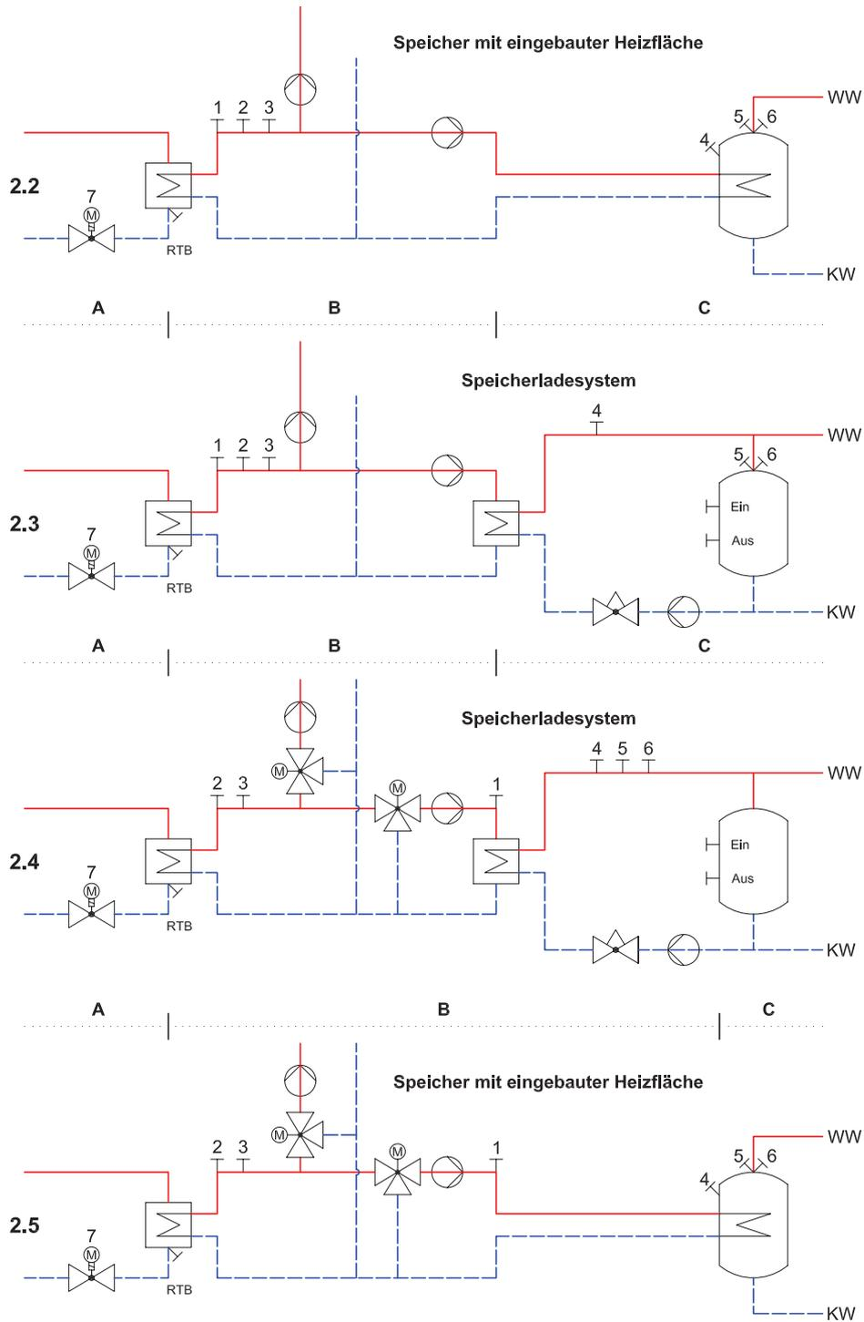
**Hauszentrale- Trinkwassererwärmung – alle Netzfahrweisen
