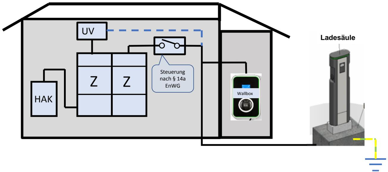
HAK = Hausanschlusskasten / UV = Unterverteilung / Z = Zähler
