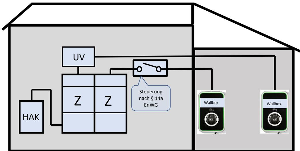
HAK = Hausanschlusskasten / UV = Unterverteilung / Z = Zähler
